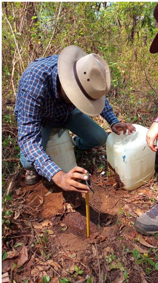
Anexo 73. Prueba de Infiltración en Día Lluvioso.
