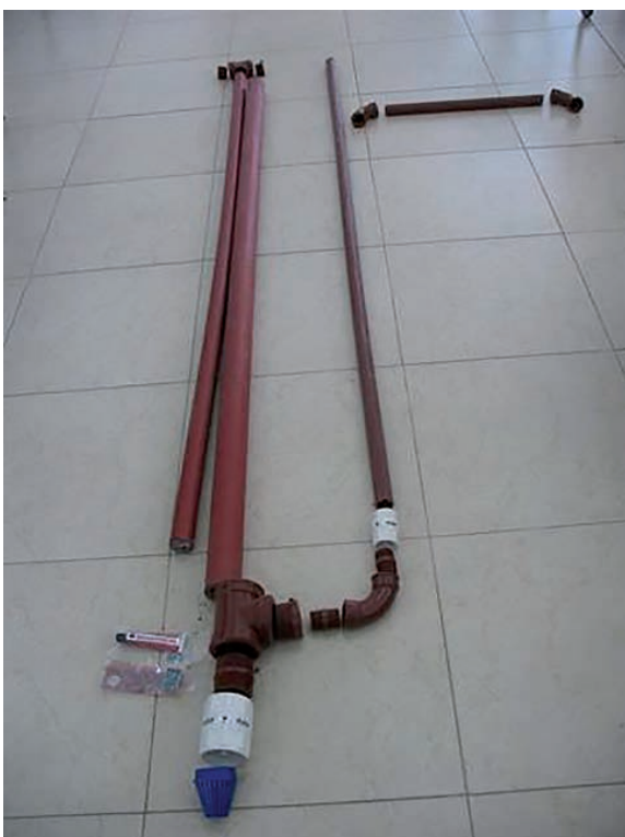
Figura 12b. Desglose de una bomba a pistón que se puede construir con material de polipropileno
