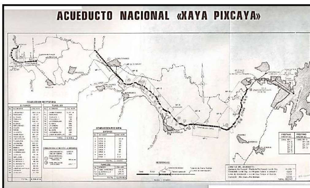
Figura 25. Línea de captación y conducción del acueducto Xayá-Pixcayá.
